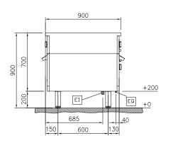
Electrical inlet (power) **Equipotential screw**
